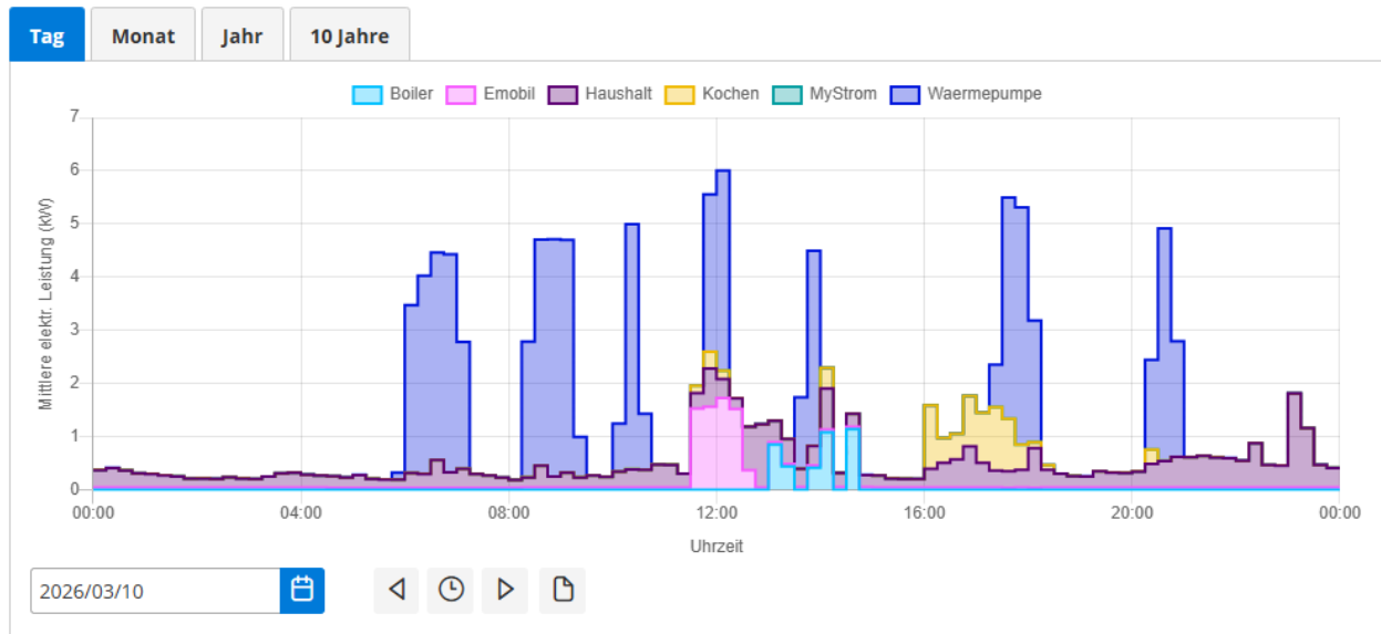
Abbildung 45: Beispiel einer Visualisierung der täglichen elektrischen Leistungsverläufe im 15-Minuten-Intervall, taktende Wärmepumpe
