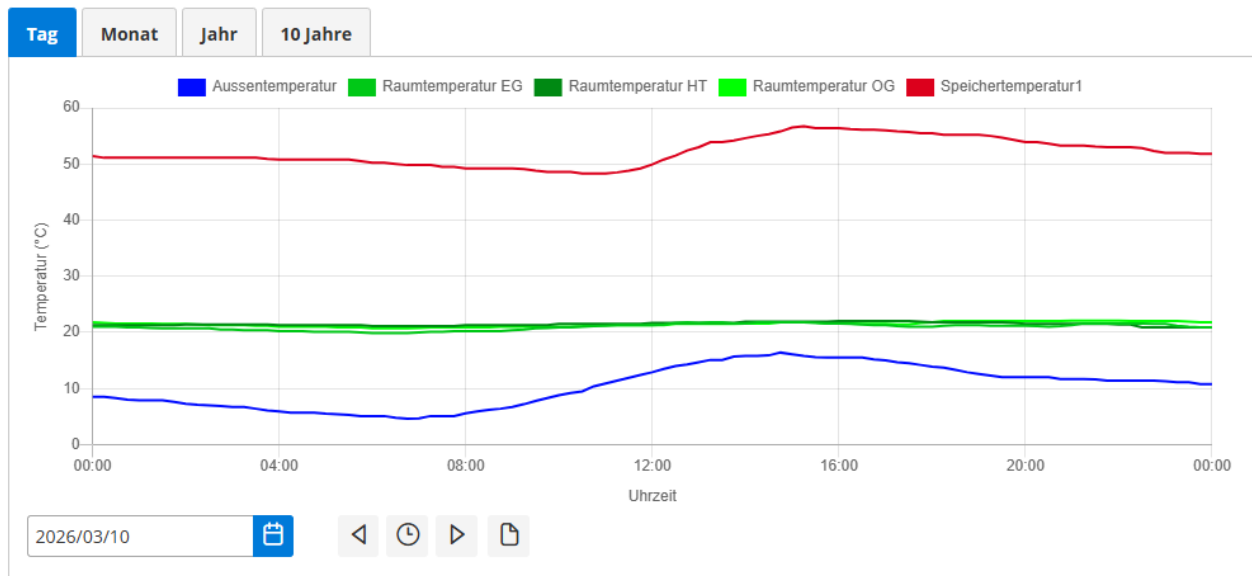
Abbildung 75: Zeitlicher Verlauf der Temperaturen im 15-Minuten-Takt über einen Tag
