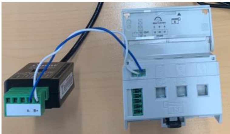
Abb. 14 Anschluss Zähler an USB Konverter, A <-> A, B <-> B
