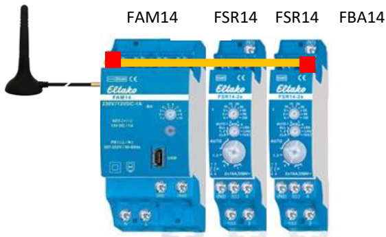
Abb. 20: Baureihe 14 mit Bus-Verbindung (orange: Steckbrücken, rot: Abschlusswiderstände)
