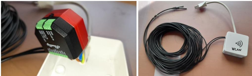
Abb. 54 Links: Shelly «Add-On Plus» (schwarz) auf Shelly «1PM Relay» (rot) aufgesteckt. Rechts: Shelly-Module in Aufputz-Gehäuse verpackt mit angeschlossenen Pt100-Fühlern (rechts)
