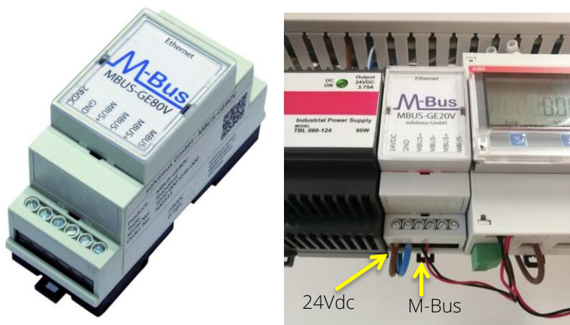
Abb. 17: M-Bus Gateway Typ Solvibus MBus-GE20V (rechts: Anschluss Bus-Leitung A/B und Spannungsversorgung 24Vdc)
