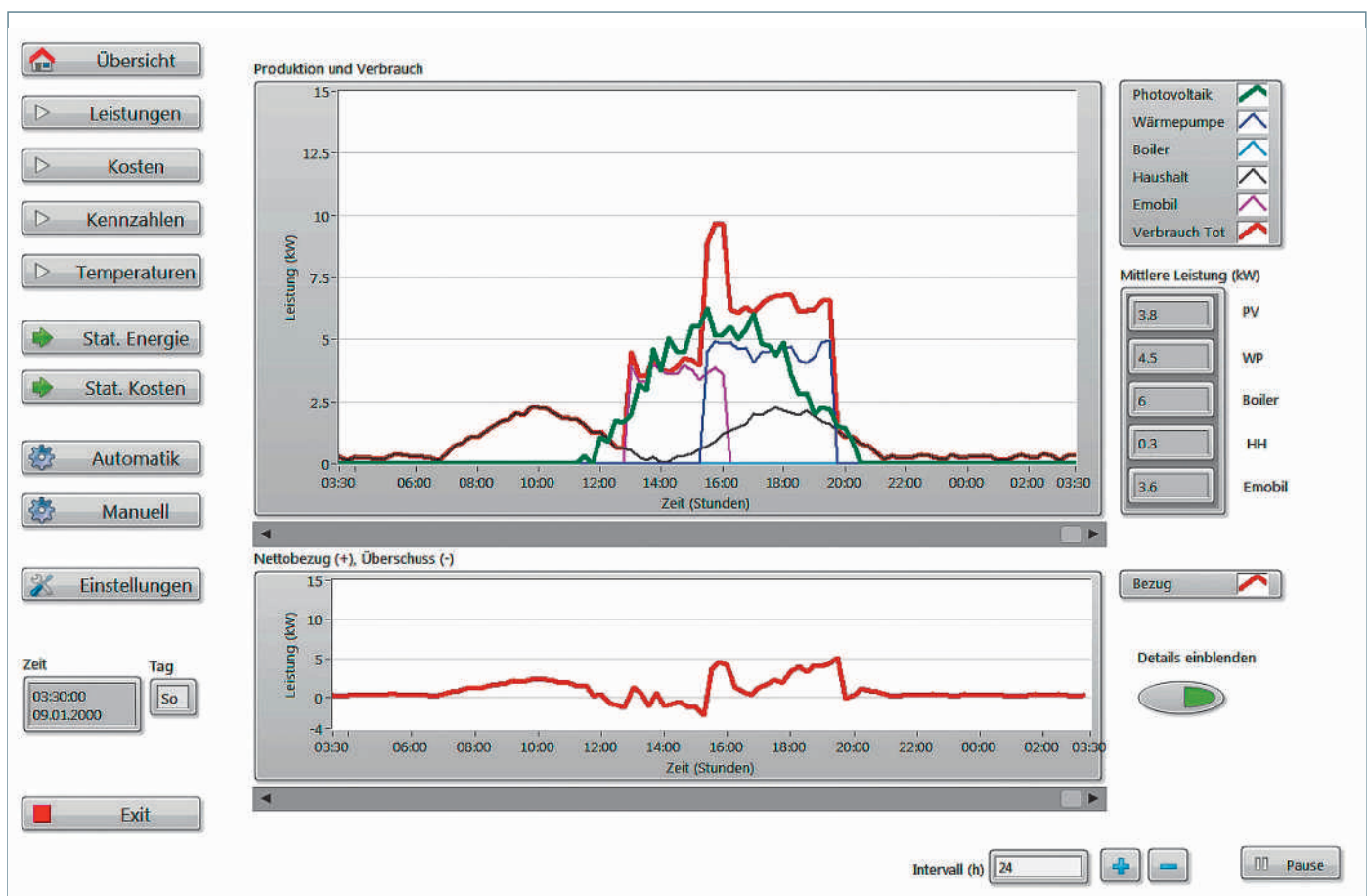
Abb. 8: Bedienoberfläche mit Leistungsverläufen (kW) für alle Produzenten und Verbraucher (oben) und aktueller Leistungsbilanz (unten: positive Werte für Bezug, negative Werte für Einspeisung).
