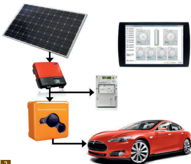
Kopplung von Photovoltaik-Anlage und Elektromobil über intelligenten Laderegler und Eigenverbrauchsmanager 5 .
